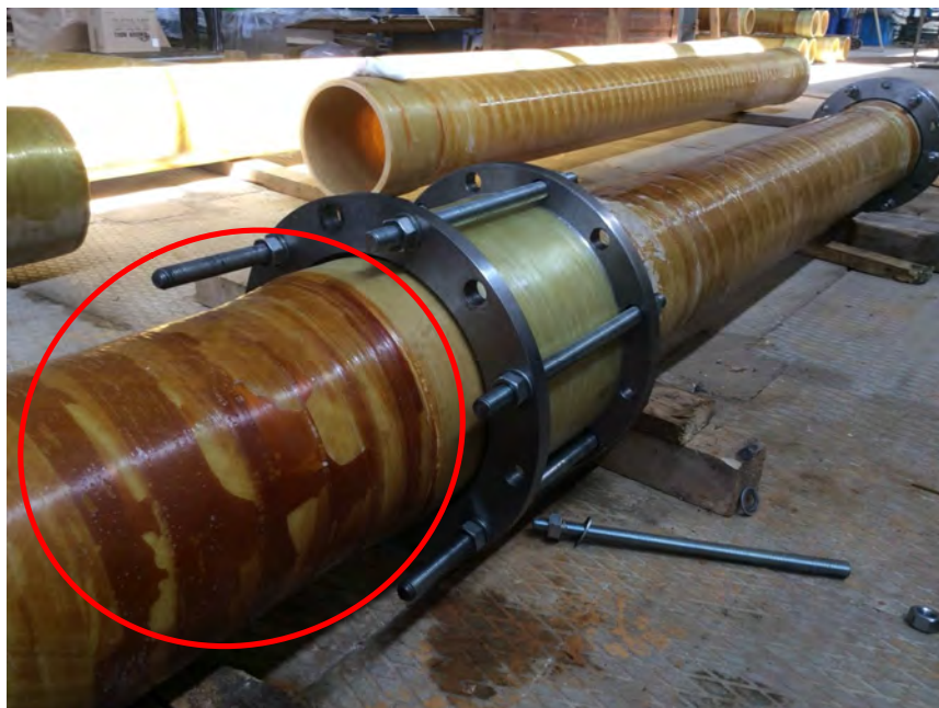
Сколы при удалении подтеков на трубе, появившихся в процессе полимеризации. Более темный цвет за счет увеличения времени полимеризации в термопечи.
