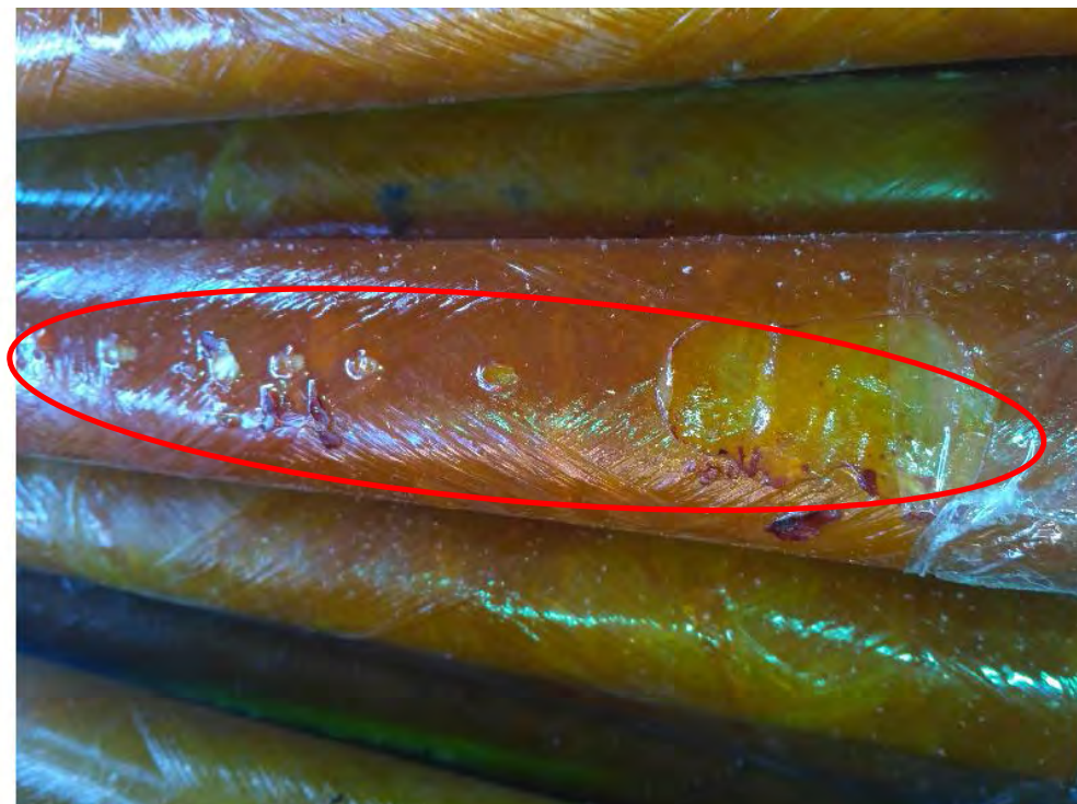
Сколы при удалении подтеков на трубе, появившихся после прохождения полимеризации в термопечи
